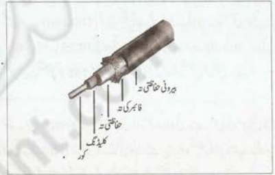
شکل 5.3 .... فائبر آپٹک کیبل کی ساخت
